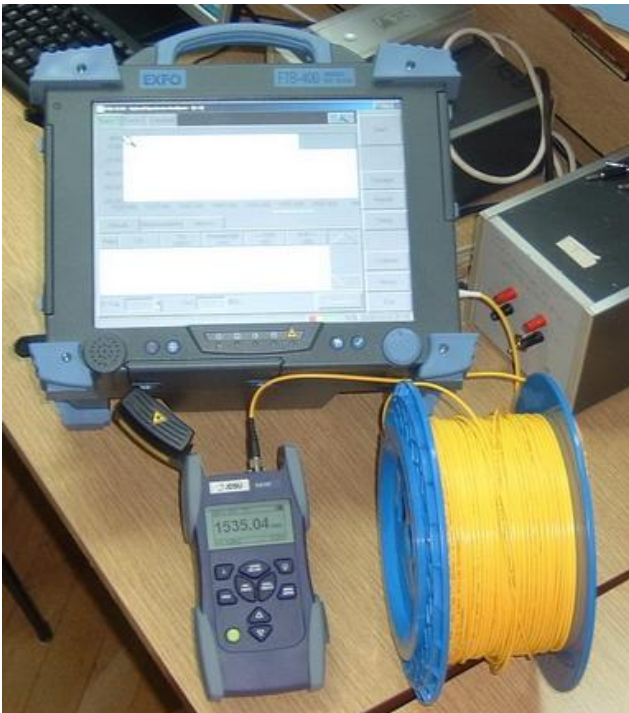
Sl. 7. Povezivanje TLS 55C i FTB 5230
