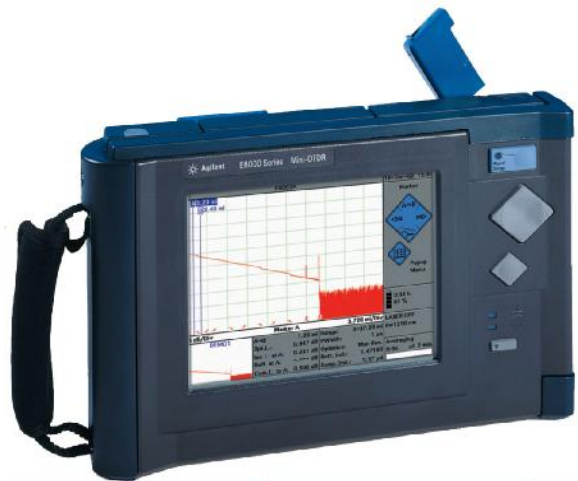
Sl. 3. E6000 Agilent Mini-OTDR
