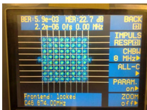
Sl. 3. Slučaj slabog prijema za repetitor u klasi "A" (bez filtra propusnika opsega)
