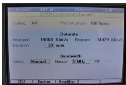
Sl.4. Slučaj protoka za 16-QAM, 8K, \Delta=1/4 , kodni količnik 3/4 (protok 14.929kbit/s),
