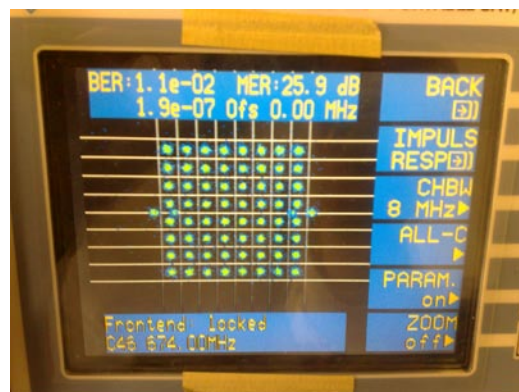
Sl. 6. Konstelacioni dijagram korektnog prijema s MER-om od oko 26dB
