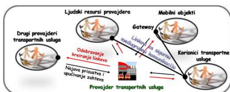
Sl. 2. Princip uspostavljanja i održavanja komunikacionih linkova između elemenata koji su uključeni u proces realizacije transportne usluge, kao i elemenata iz eksternog okruženja provajdera.
